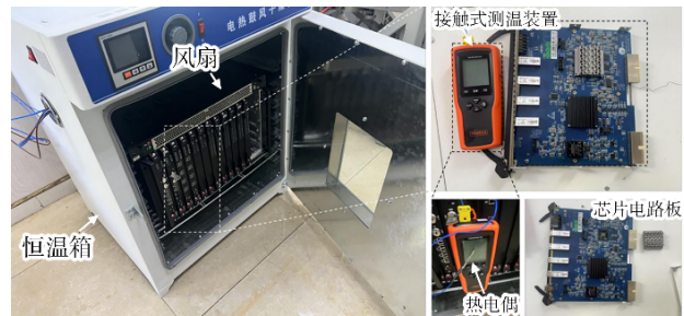
图11 定温烘箱和测温装置实物及芯片电路板
